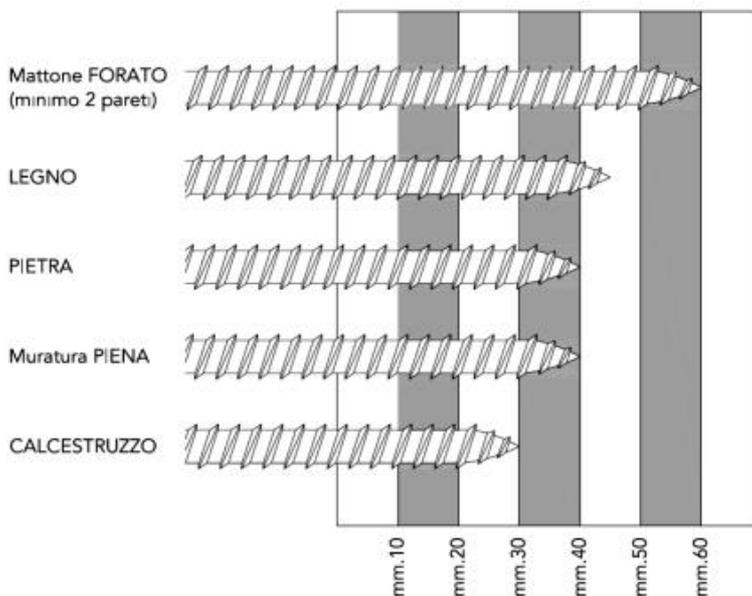
La lunghezza totale della vite, sarà individuata aggiungendo lo spessore del controtelaio e dello spazio tra controtelaio e muro.
