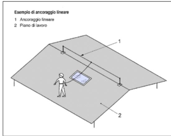
**Ancoraggio di estremità:** elemento iniziale o terminale di un dispositivo di ancoraggio lineare di tipo C oppure di tipo D che collega l'estremità di una linea di ancoraggio flessibile o di una linea di ancoraggio rigida alla struttura.
