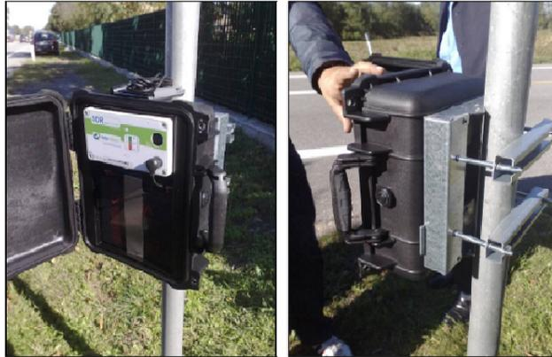
Figura 12 - Esempio radar SDR EASYDATA
