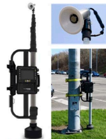
**Figura 18 – Strumentazione video con palo telescopico**
