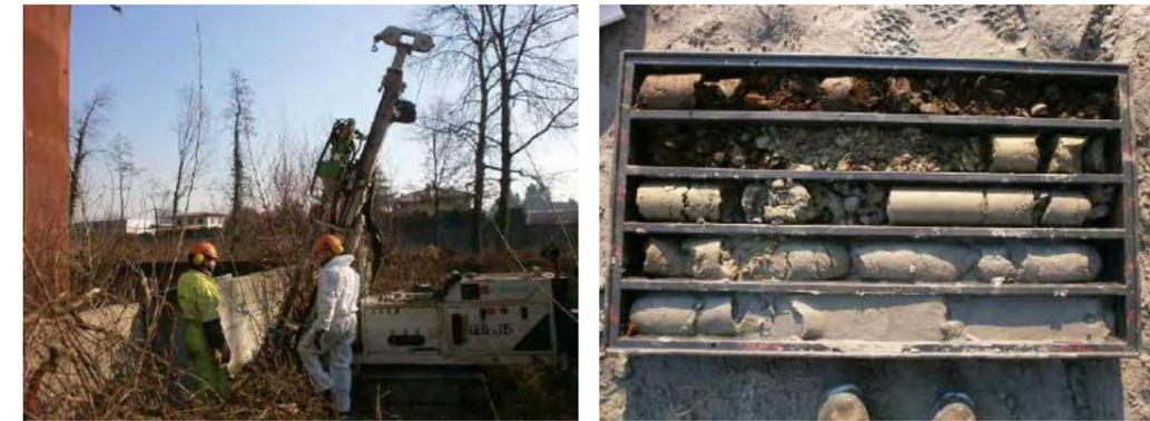
Figura 11. Esecuzione sondaggio e esempio di materiale riposto in cassetta catalogatrice
