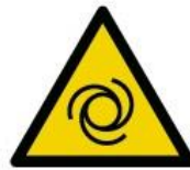
W018 Pericolo Avvio automatico
