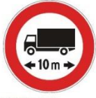
Figura II 67 Art. 118 TRANSITO VIETATO AI VEICOLI, O COMPLESSI DI VEICOLI, AVENTI LUNGHEZZA SUPERIORE A .... METRI
