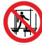
P025 Non utilizzare un'impalcatura incompleta
