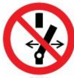
P031 Non modificare la posizione dell'interruttore
