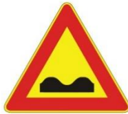
Figura II 389 Art. 31 STRADA DEFORMATA
