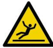
W011 Pericolo Superficie scivolosa
